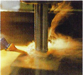
Durch Funkenerosion werden allerfeinste Strukturen in die Werkzeugformen hineingearbeitet.
